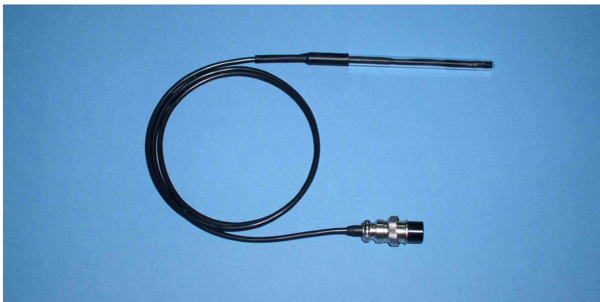
Zdjęcie czujnika temperatury przyrządu ATLAS 0961 MBI
